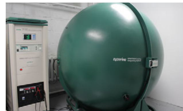
Спектрорадиометр и интегрирующая сфера
