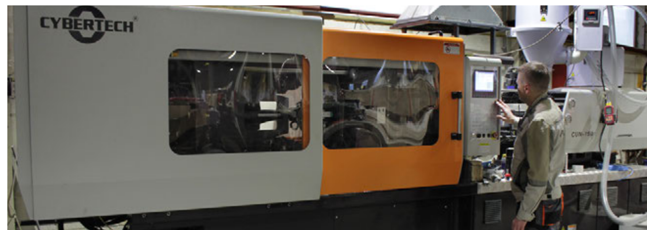
Производство пластиковых деталей корпусов и оптических линз методом литья под давлением
