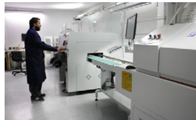
Линия автоматического монтажа SMD
