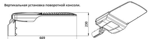
Угол регулировки поворотной консоли  $\pm 20^\circ$  с шагом  $5^\circ$ .
