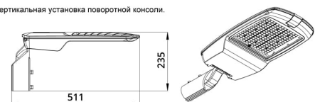
Угол регулировки поворотной консоли \pm 15^\circ с шагом 5^\circ .
