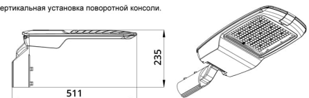
Угол регулировки поворотной консоли \pm 15^\circ с шагом 5^\circ .
