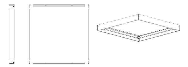
Накладное крепление может быть смонтировано на основной потолок или на декоративную плитку с помощью метизов из комплекта. Если необходимо подготовить отверстия, после сборки, необходимо прислонить крепление к потолку и сделать разметку по монтажным отверстиям в корпусе накладного крепления. Соблюдайте перпендикулярность боковых стенок, в случае необходимости – воспользуйтесь угольником.
