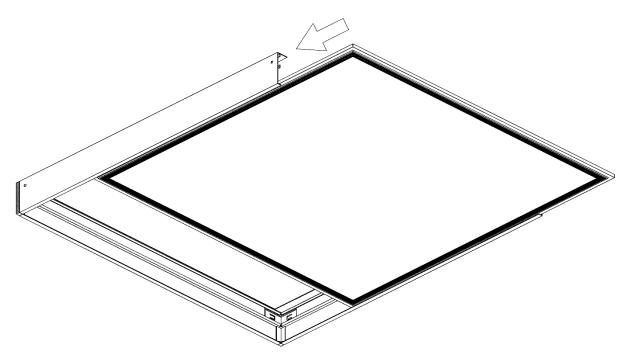
Драйвер при накладном монтаже располагается в свободном пространстве между корпусом светильника и боковиной крепления. Обратите внимание на длину кабеля от драйвера, заранее спланируйте возможность подключения.
