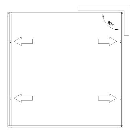
Осуществите монтаж накладного крепления с помощью крепежа из комплекта.
