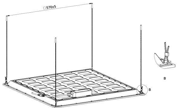
После монтажа светильника, отрегулируйте высоту подвеса и выставьте светильник горизонтально, подключите светильник.
