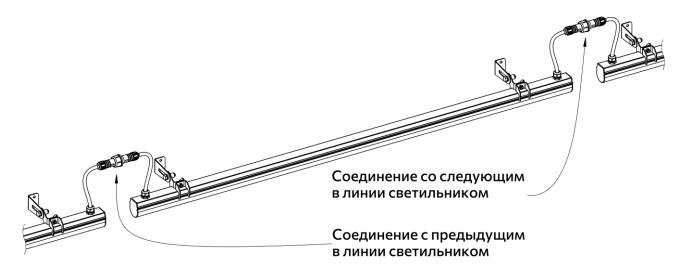
Структура транзитного подключения первого и последнего в линии светильников без монтажного профиля:
