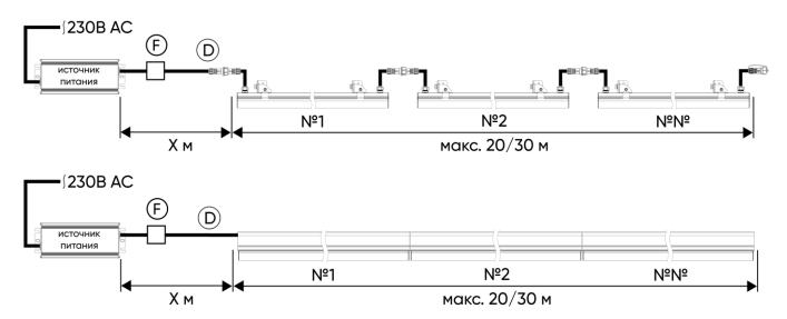
F – герметичное клеммное соединение или распределительная коробка, D – вводной кабель.
