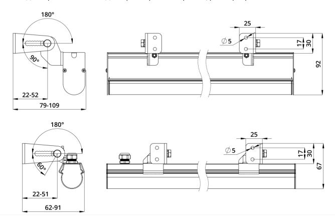
Для одиночных светильников с монтажным профилем предусмотрены торцевые крышки с отверстием для вывода кабеля. Момент затяжки винтов торцевых крышек – не более 1 Н·м. Транзитные светильники с монтажным профилем опционально могут быть укомплектованы торцевыми крышками для оформления первого и последнего светильников в линии.
