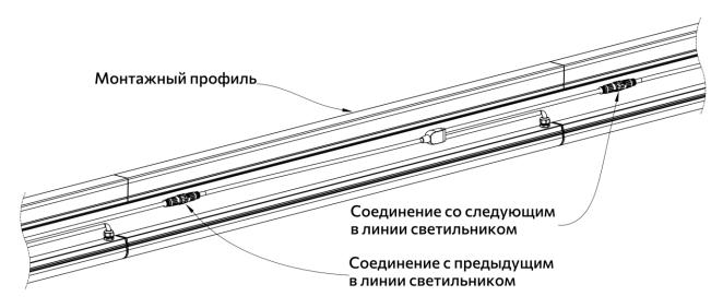
Структура транзитного подключения первого и последнего в линии светильников с монтажным профилем:
