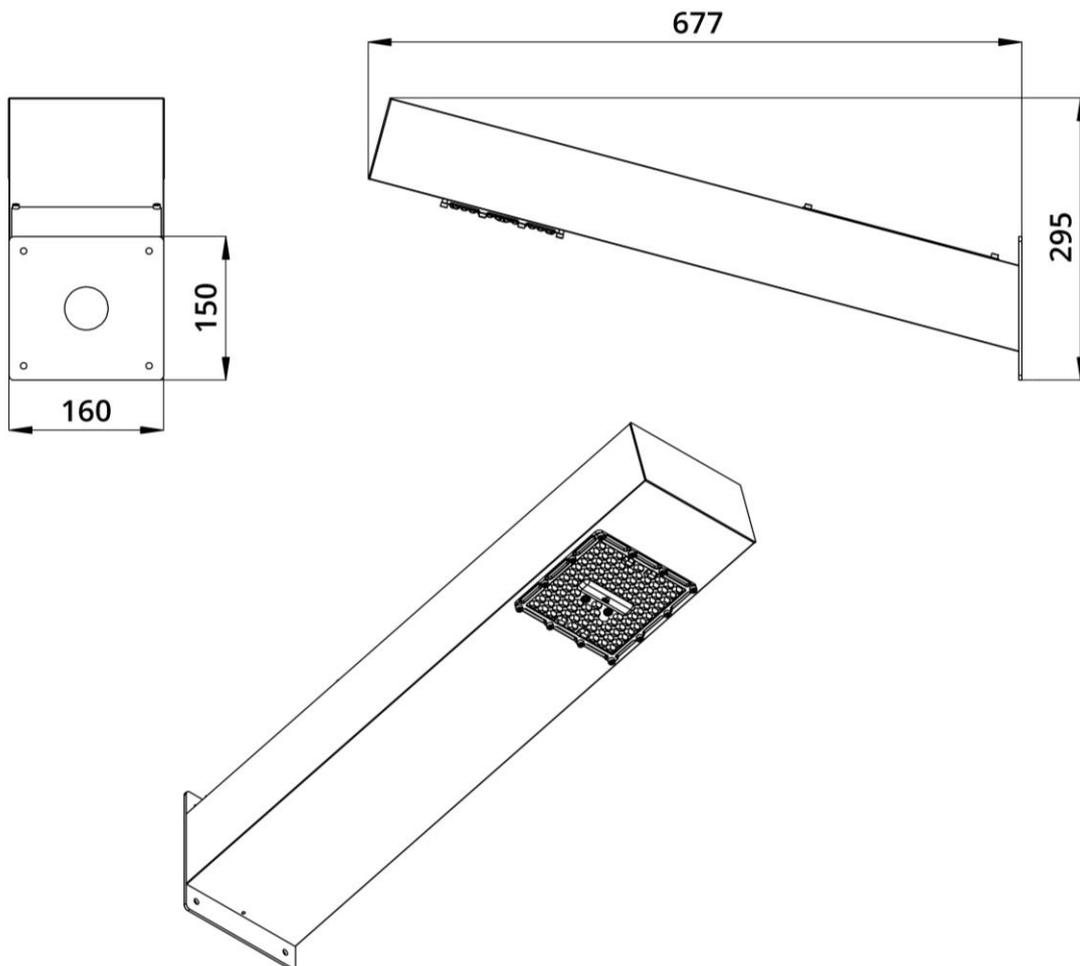
В конструкции предусмотрен монтажный фланец для крепления светильника к поверхности. По центру фланца расположено отверстие для ввода внешнего кабеля питания светильника. Перед монтажом светильника, необходимо подготовить крепежные отверстия исходя из размеров на чертеже.
