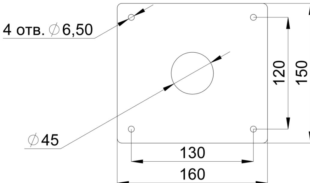
В месте установки светильника необходимо подготовить плоское основание для прилегания монтажного фланца. Используемый крепеж выбирается индивидуально для каждого проекта, в зависимости от материала опорной поверхности и в комплект светильника не входит.
