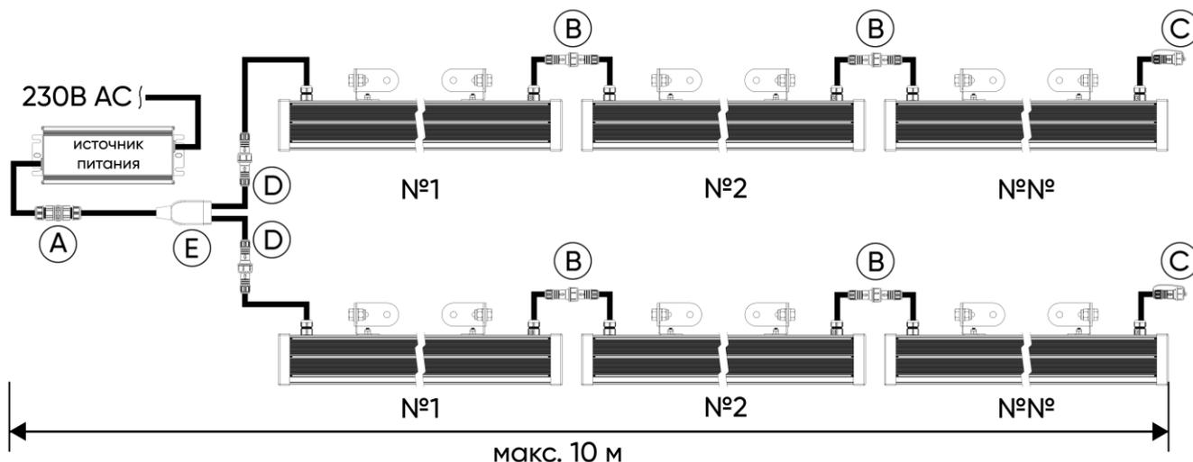
А – герметичная клеммная колодка, В – штепсельные разъемы, С – заглушка, D – вводной кабель, E – «Y»-коннектор или распределительная коробка
