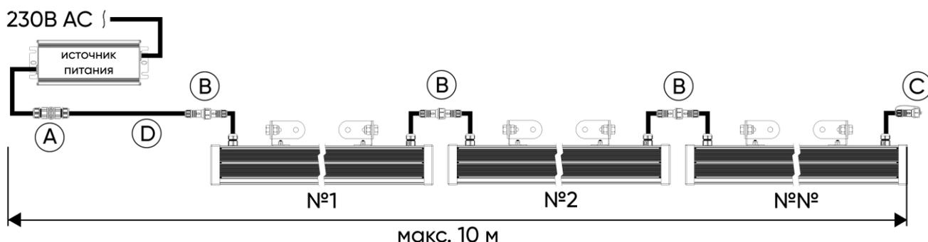
А – герметичная клеммная колодка, В – штепсельные разъемы, С – заглушка, D – вводной кабель
