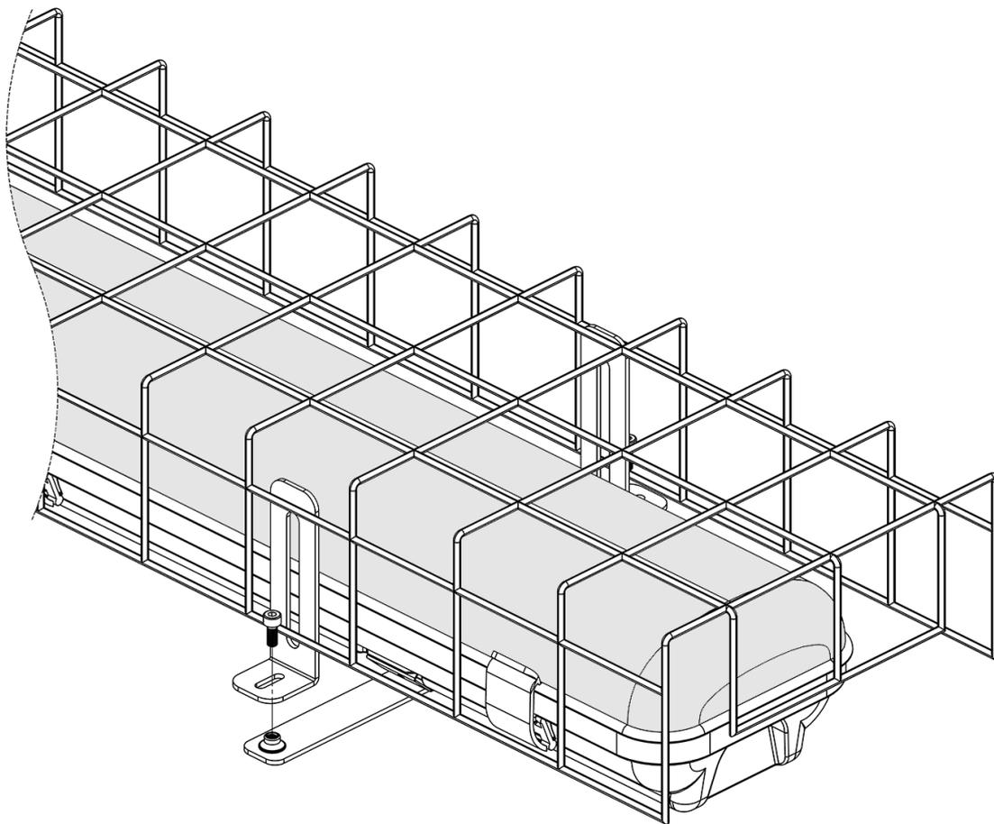
Монтаж защитной решетки производится с помощью метизов, входящих в комплект поставки. Так же, возможно закрепить решетку на опорную плоскость напрямую, без монтажной пластины.
